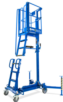
Ixolift 400WS Hauteur de travail: 3,97 m Poids: 239 kg
